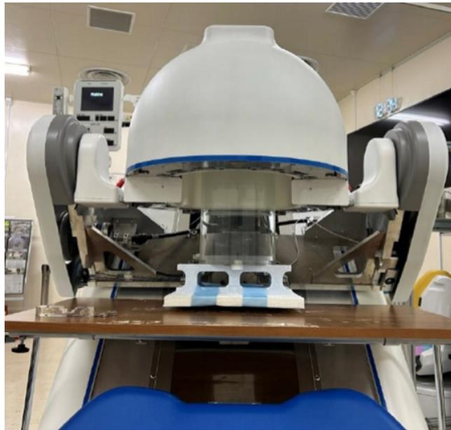
Figure 16: ヘルメット型頭部専用 PET 装置における円筒型ファントムの配置
